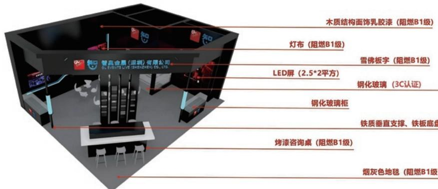
图注：使用材料符合消防阻燃B1级以上要求
